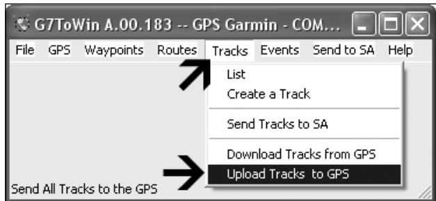
Bild 4: G7ToWin – Tracks und Waypoints zum GPS-Empfänger übertragen
